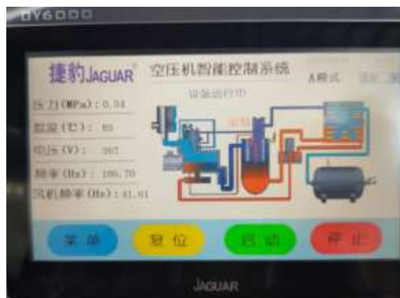
節能螺桿空氣壓縮機的操作介面
